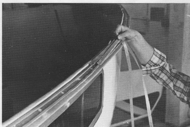
Bild 14 En sträng tätningsmedel på var sida om skruvhålen
