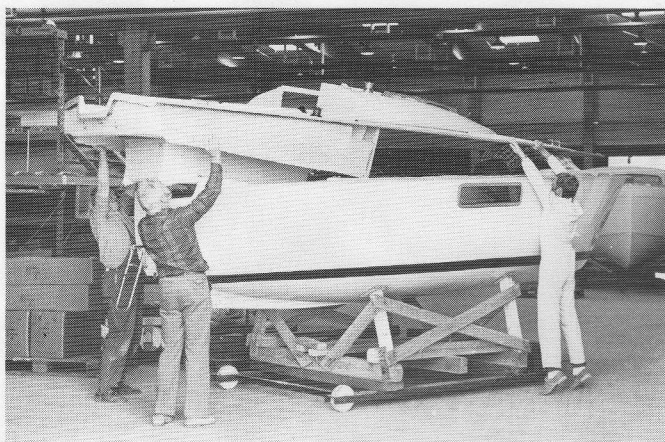
Bild 11 Påläggnig av däck
