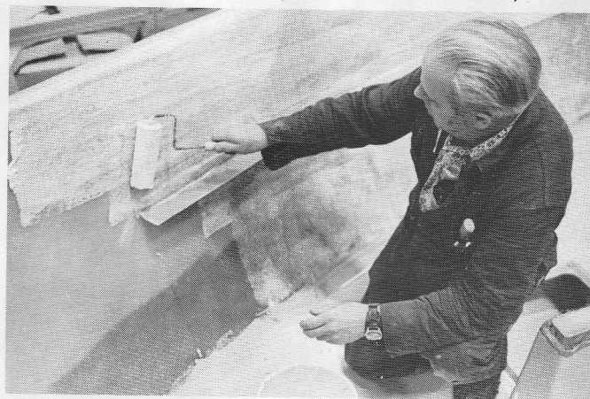
Bild 6 Påläggning av lim för skrovbeklädnad
