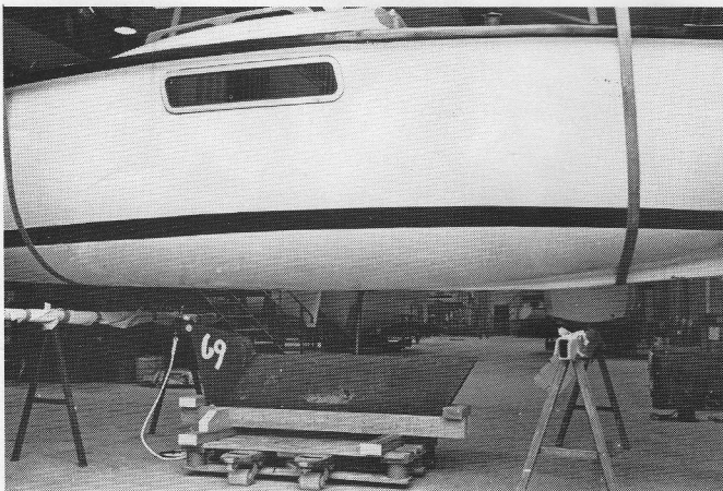
Bild 21 Skrovet sänks ned över kölen
